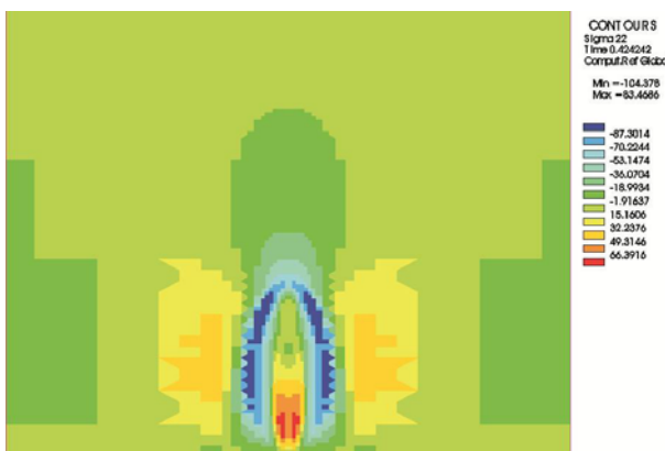
Abbildung 21: Transient berechnete Quereigenspannungen (Min. -104,4 MPa, Max. 83,5 MPa)
